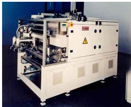
Bild 1: Gelier- und Aushärteanlage von GTL Knödel
