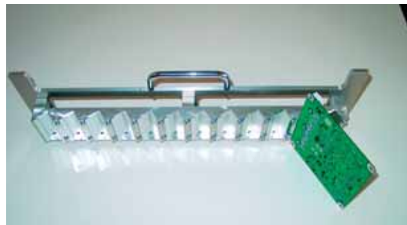
Bild 10 Typische Werkstückaufnahmen des perfecta-Systems
