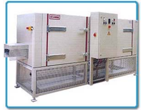
Bild 2: Bandanlage zur Wärmebehandlung in der Elektronikfertigung (Bild: Knödel)
